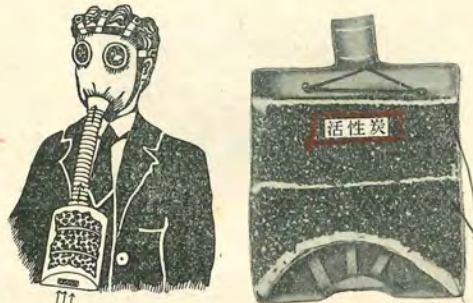
[8圖] ガスマスク(左)と吸収罐(右)
